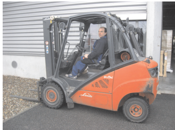
Messung von Ganzkörperschwingungen beim Staplerfahren
