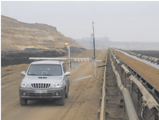
Mobiles Bandüberwachungssystem MOBASAVE (Entwickelt im Auftrag der RWE Power AG)
